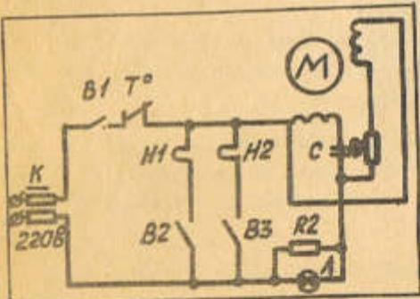
М - электродвигатель ЭДГ-6А со скоростью вращения 2750 об/мин напряжение 127 В ГОСТ 14191-72
